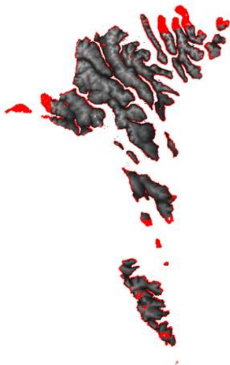
Markering med rødt af "dårlige" eller manglende data i den første DTM, som blev genereret i 2015 .
