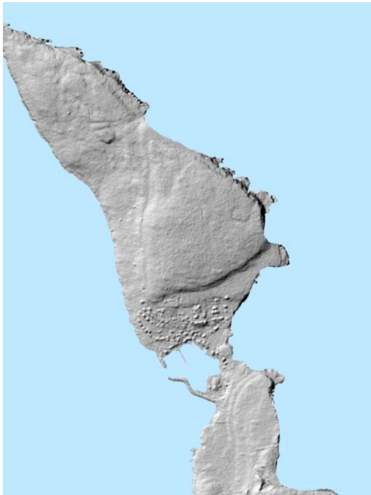
Eksempel på en simpel hillshading af højdemodellen, hvorved terrænets former træder tydeligt frem
